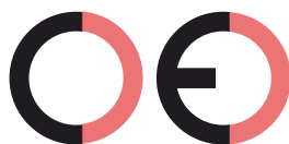
Faux marquage CE (trop éloignée)
