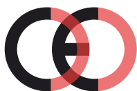
Faux marquage CE (trop proche)
